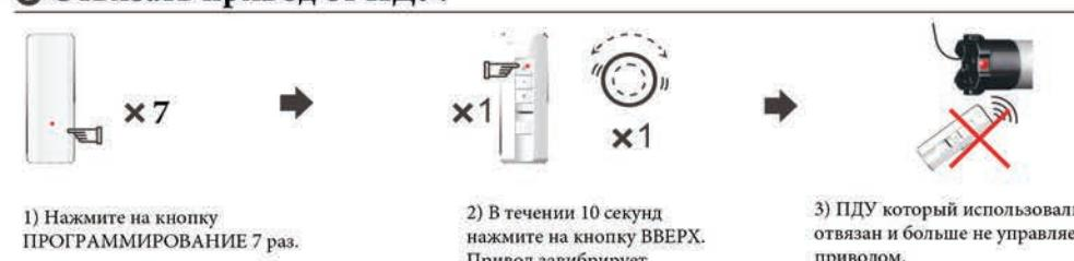
**Примечание:** Если Вы отвязали от привода основной ПДУ(А), в этом случае ПДУ(Б) так же не сможет управлять приводом. Если данным способом отвязали ПДУ(Б), то через ПДУ(А) возможно управлять приводом.
